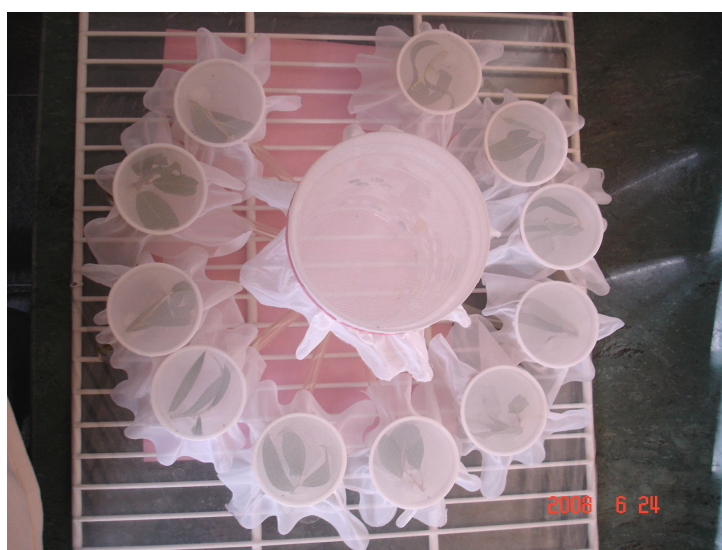
شکل ۱- دستگاه بویایی سنج شده برای بررسی مکانیسم مقاومت آنتی زنوزی گونه‌های بید نسبت به سنک بید و صنوبر
